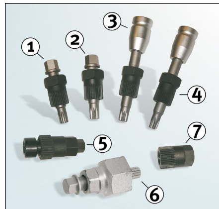
Obrázok 5: Potrebné špeciálne náradie pre demontáž a montáž rôznych rovnobežných remeňov
