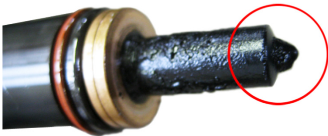
Obr. 3: Jednotka vstrekovania paliva zanesená karbónom
