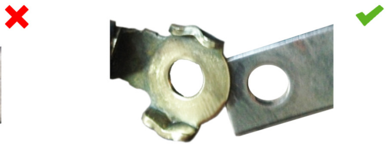
Obr. 2: Uzemnenie po očistení: kontakt dobrý
